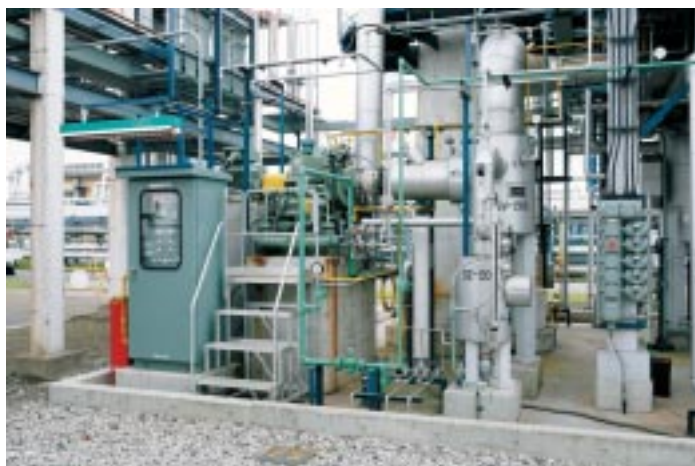
HIDiC (省エネ型内部熱交換器蒸留塔)の付帯コンプレッサーで塔内の半分の濃縮部を高温にして塔内の他方の回収部に熱を供給するための心臓部です。
