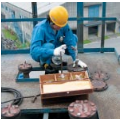
*排ガス(NO x , SO x )測定 エチレン製造装置分解炉の排ガス定期測定状況
