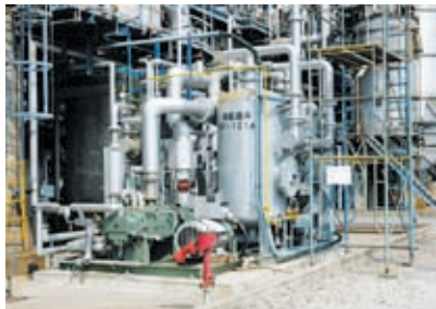
*ベンゼン回収設備 ベンゼン船への荷積の際、大気に放出されるベンゼンを当装置で回収しています。(2004年12月稼働)
