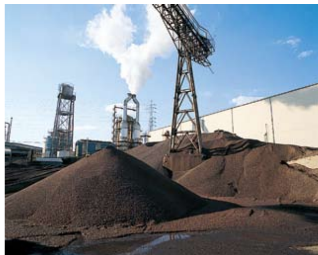
汚泥類からリサイクルされた建設骨材(日本メサライト工業株)
