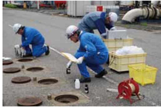
土壌浄化対策技術委託先による地下水採取作業
