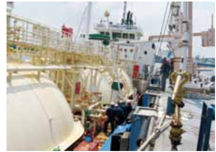
プロピレン積み込み用ローディングアーム 接続作業
