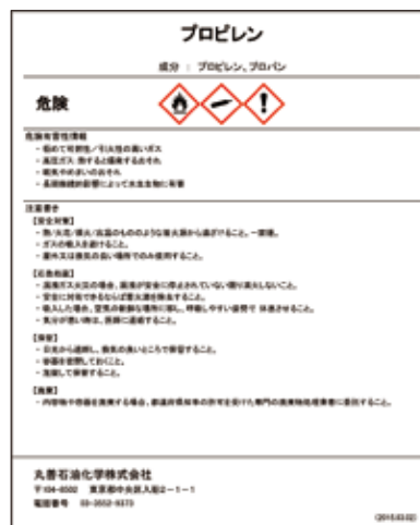
警告表示ラベルの例 (プロピレン)
